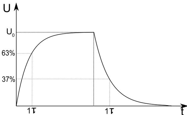
Abb. 10: Auf- und Entladekurve eines Kondensators: Spannung  $U$  in Abhängigkeit von der Zeit  $t$ . Die Zeitkonstante  $\tau$  ist auch eingezeichnet.
