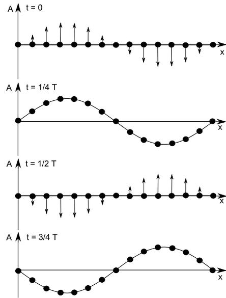
Abb. 4: Eine schwingende Saite der Länge  $L$ : Die schwarzen Punkte stellen die punktförmigen Abschnitte der Saite dar, die Pfeile kennzeichnen Tempo (die Länge des Pfeils beschreibt das Tempo) und Richtung der momentanen Bewegung.
