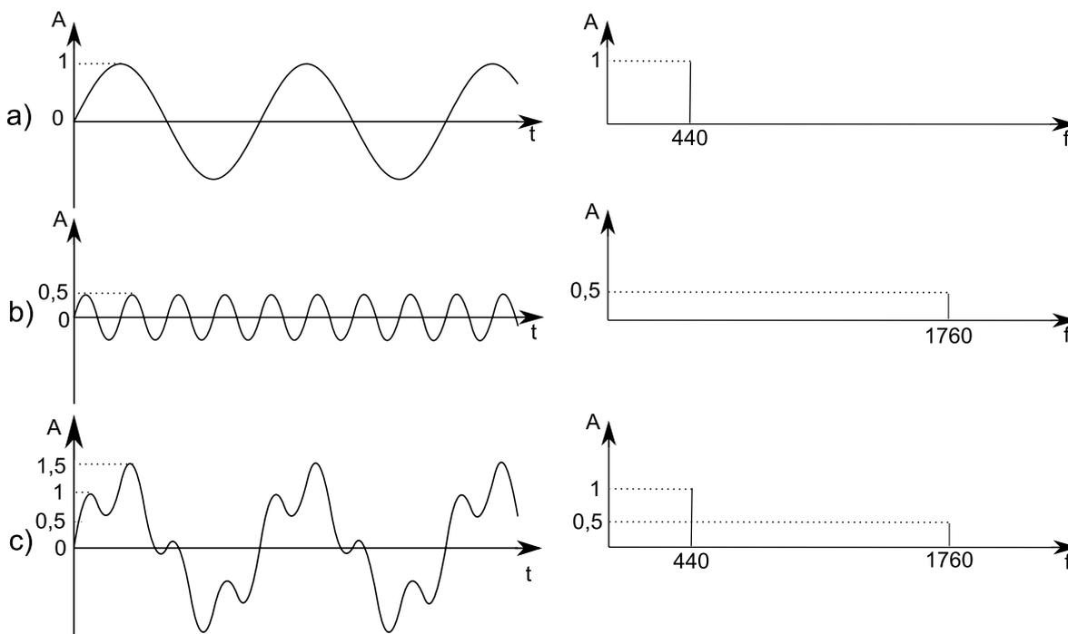
Abb. 7: Grund- und Oberton des Kammertons a', sowie deren Überlagerung. Darstellung links im  $x-t$ -Modus und rechts als Frequenzspektrum.
