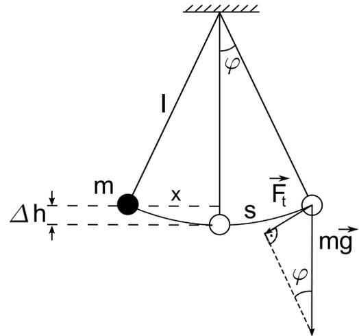
Abb. 16: Fadenpendel mit Masse  $m$  und Fadenlänge  $l$ . Die Ruhelage des Pendels liegt bei  $\varphi = 0$ .
