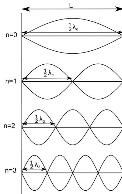
Abb. 5: Grund- und Obertöne einer schwingenden Saite der Länge  $L$ . Die Abbildung zeigt die Amplitudenausschläge in beide Richtungen.
