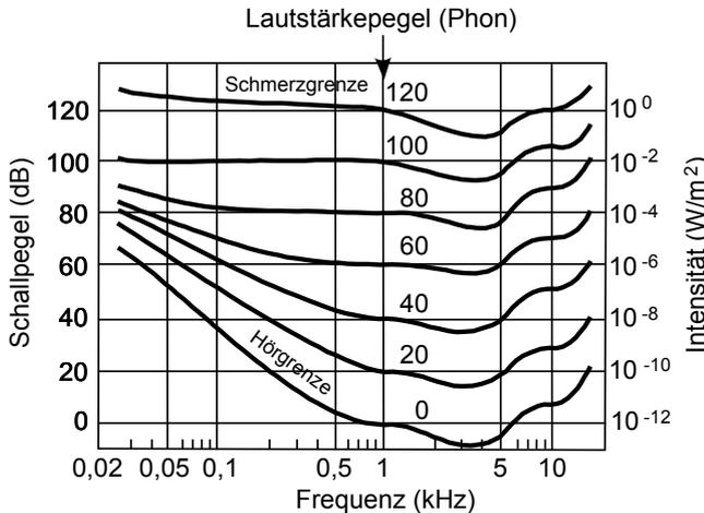
Abb. 6: Frequenzabhängigkeit des menschlichen Hörvermögens. Jede Linie entspricht der gleichen Lautstärke.
